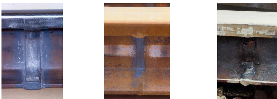
Rys. 3. Spoina termitowa, zgrzeina i spoina wykonana elektrodą otuloną
