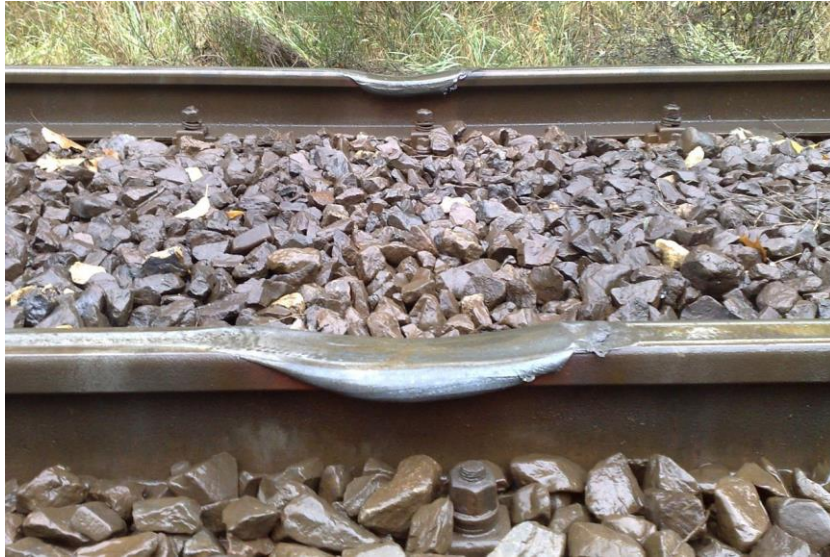
Rys. 5. Wybuksowanie szyny o głębokości 18 mm i długości 370 mm (fot. D. Sikorski)
