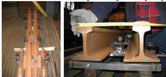
Rys 16 i 17. Pomiar rozstawu szyn w krzyżownicy rozjazdu R=1200
