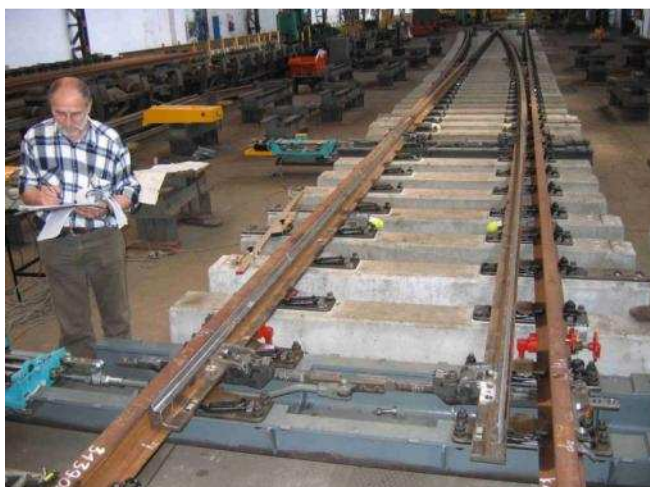
Rys. 1. Odbiór rozjazdu u producenta w firmie KolTram sp. z o.o. w Zawadzkiem
