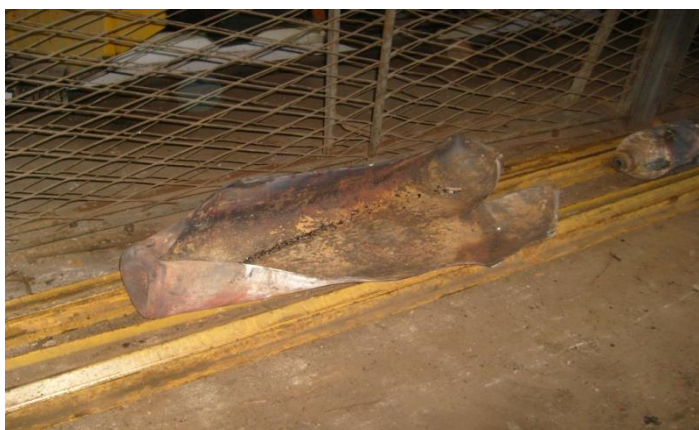
Rys.8. Uszkodzona butla na skutek cofnięcia płomienia Źródło: PKP PLK S.A. - IG Warszawa
