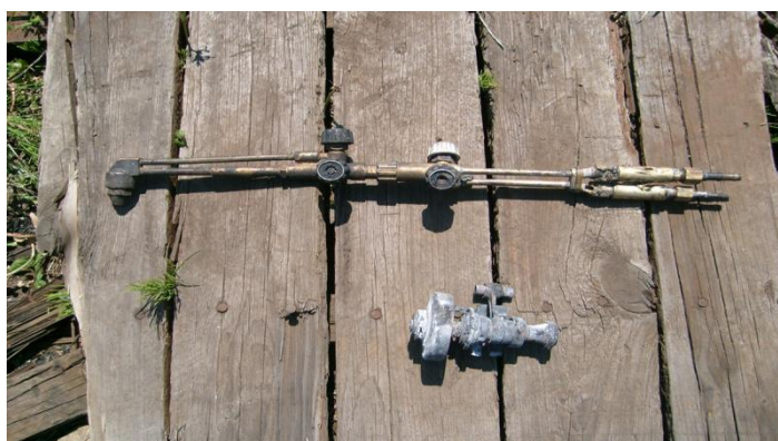
Rys.7. Uszkodzony palnik na skutek cofnięcia płomienia Źródło: PKP PLK S.A. - IG Warszawa
