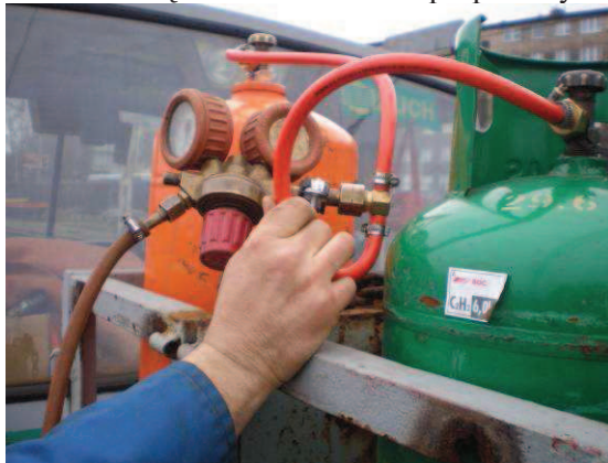
Fot. 10. Połączenie dwóch butli propanowych.
