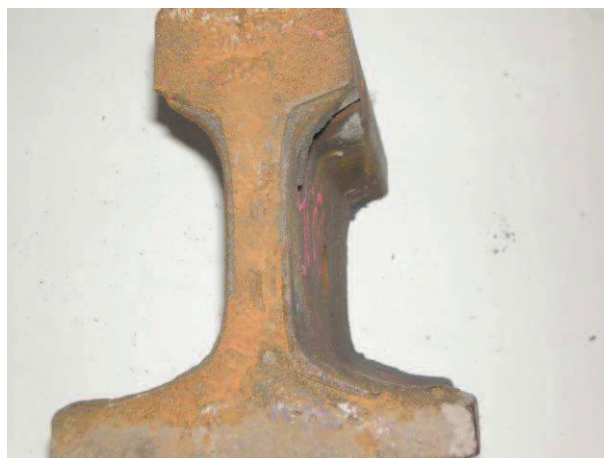
Fot. 5. Spoina wykonana w temperaturze -5^{\circ}\text{C}
