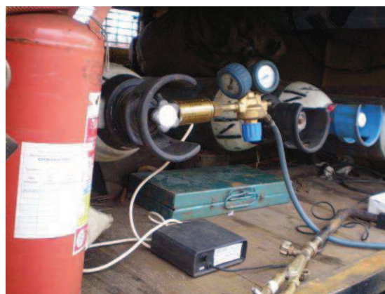
Fot. 14. Podgrzewacz elektryczny- widok kompletu.
