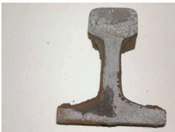
Fot. 3. Spoina wykonana w temperaturze -3\text{ }^{\circ}\text{C}
