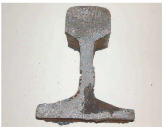
Fot. 1. Spoina wykonana w temperaturze -1°C
