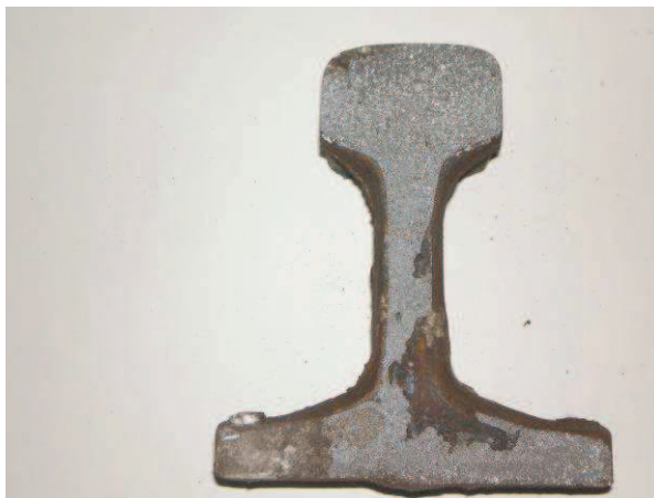
Fot. 2. Spoina wykonana w temperaturze -4\text{ }^{\circ}\text{C}
