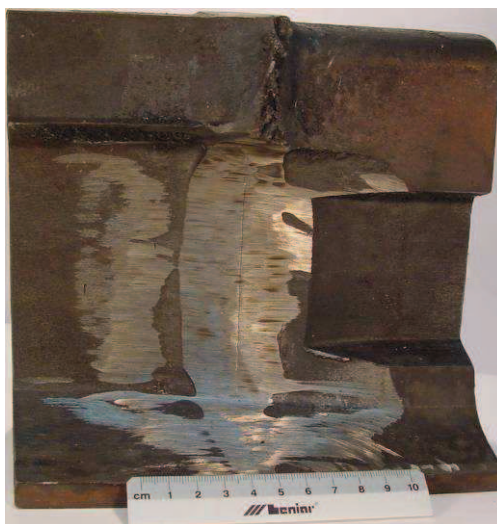
Rys. 1. Wygląd pękniętego rozjazdu. Pęknięcie rozwija się tylko w szyjce
