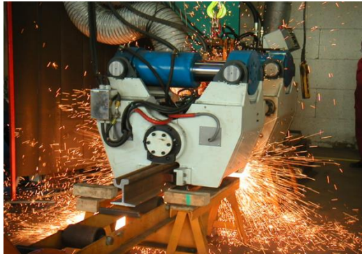
Rysunek 8. Głowica w trakcie zgrzewania szyny rowkowej.
