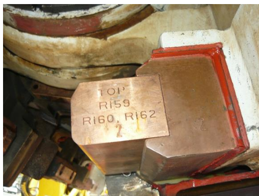
Rysunek 11. Uniwersalna elektroda do szyny rowkowej.
