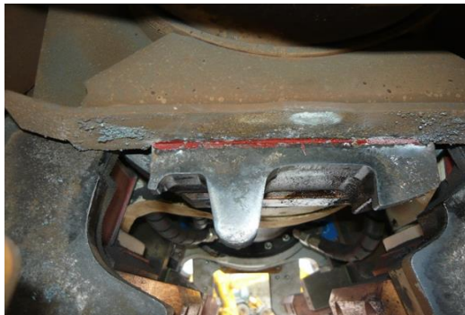
Rysunek 9. Element noża do usuwania wypłytki w rowku szyny rowkowej.
